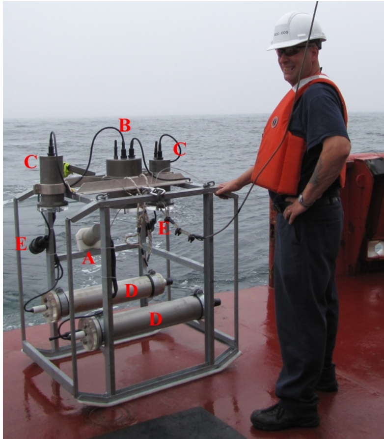
Figure 7. Système déposé sur lequel peuvent être fixées les mêmes composantes d'imagerie benthique que sur le traîneau. (A) caméra vidéo oblique, (B) appareil photo, (C) flashes, (D) caissons de batteries (accumulateurs 24V pour lampes), (E) lampes DEL ( 2 \times 45 W).
