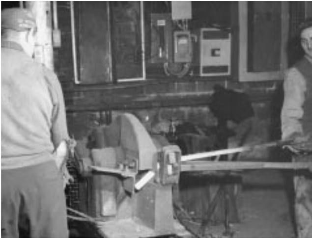
**Figure 12** Deux ouvriers de la Walters Axe Company, de Hull (Québec), opérant une presse à découper le métal pour la fabrication de haches, en 1961
