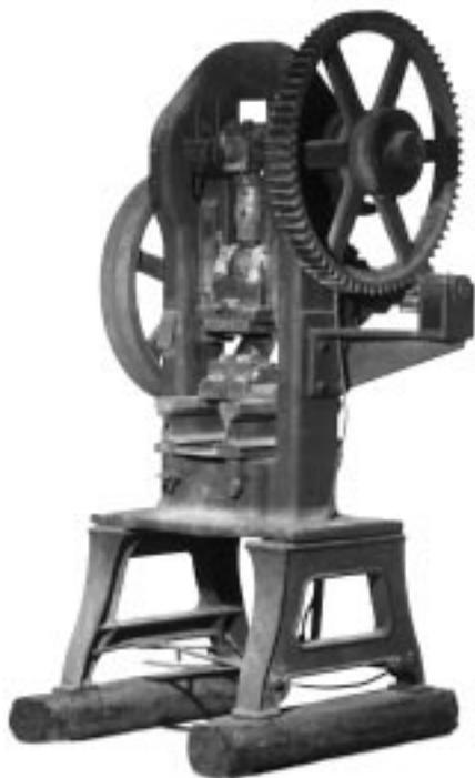
**Figure 8** Presse à façonner les haches, fabriquée au Canada et utilisée par la Walters Axe Company, de Hull (Québec), vers 1920-1970
