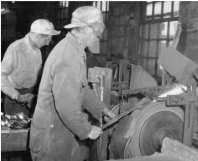
**Figure 13** Ouvriers de la Walters Axe Company, de Hull (Québec), dégrossissant des haches à la meule, en 1961
