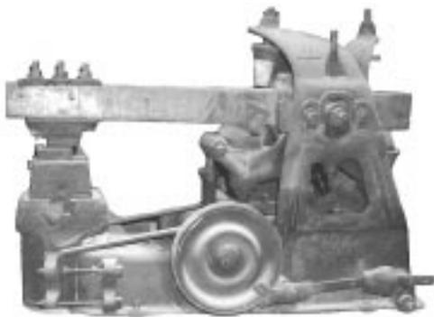
**Figure 5** Marteau à bascule coussiné (*cushioned trip hammer*), de marque Bradley, inventé durant les années 1870
