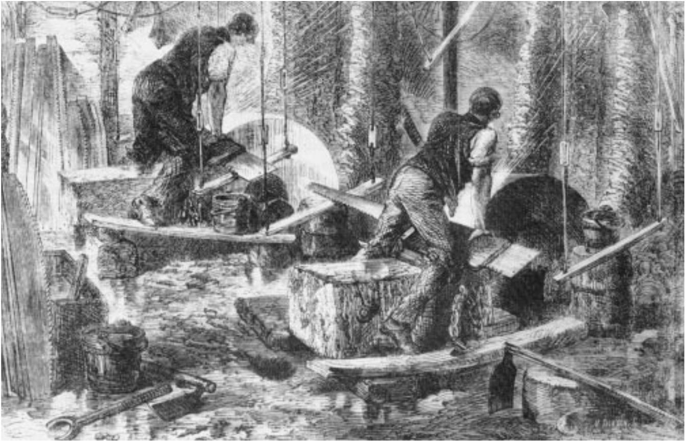
**Figure 2** Polissage à la meule des lames de scies
