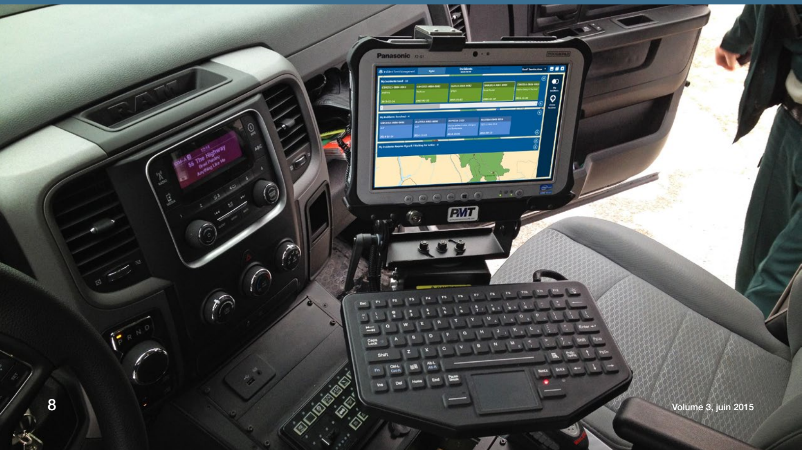
Figure 9 : Le Système de gestion des incidents et des événements (SGIE) est un système cartographique qui fonctionne sur les tablettes que les gardes de parc transportent ou qui sont installées dans leurs véhicules. Le SGIE continue de fonctionner même quand il est débranché du réseau de l'APC et des réseaux cellulaires. Quand les gardes de parc reviennent à leur bureau, le système synchronise les changements avec la base de données centrale.
