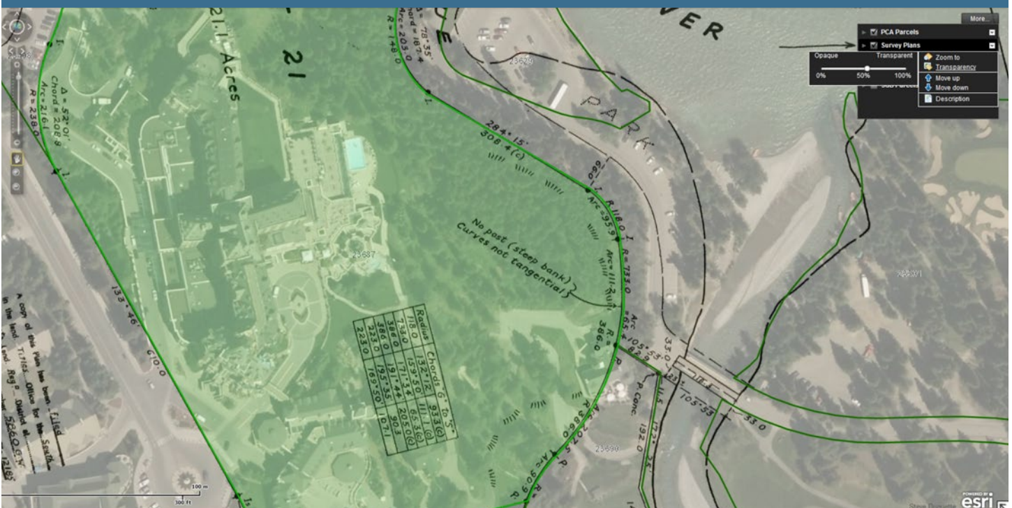
Figure 8 : Gros plan tiré du SNGBI montrant le plan d’arpentage superposé à la photographie aérienne. Ce genre de vue aide les gestionnaires de Parcs Canada à faire le lien entre le levé (et par conséquent le bail) et les éléments sur le terrain.
