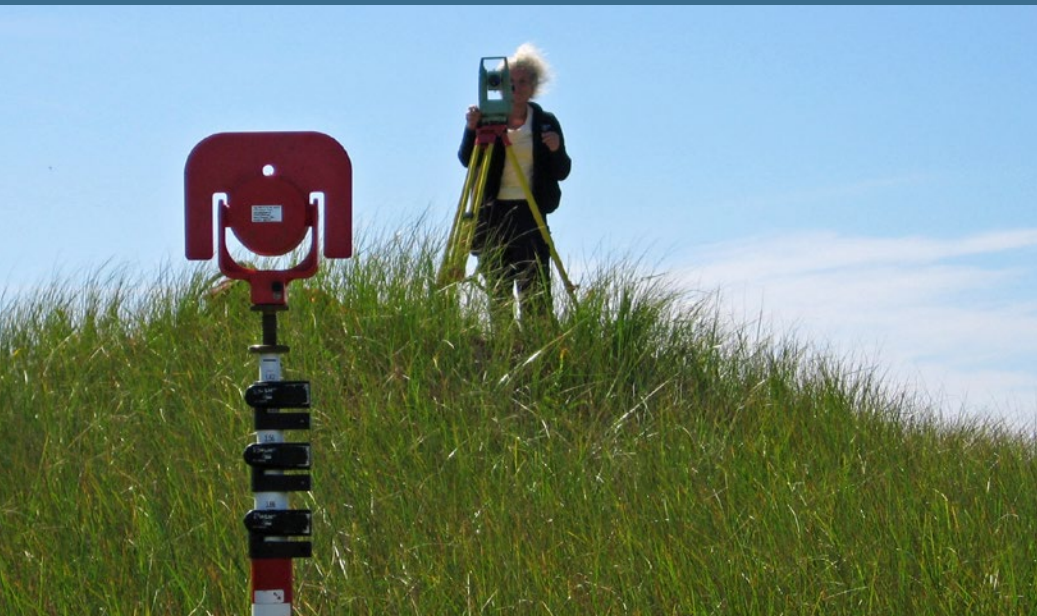
Figure 10 : dans le cadre d'un programme de surveillance d'intégrité écologique de plus grande envergure, Sally O'Grady, spécialiste de la géomatique chez Parcs Canada, effectue des levés du mouvement des dunes à Kejimikujik Bord de mer. (Photo : O. Woods, Parcs Canada)
