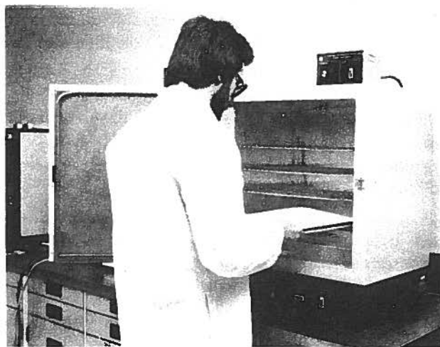
Figure 7: Le gel de silice peut être séché par chauffage dans un four à 120 °C pendant 12 heures.
