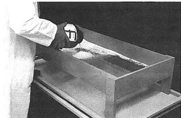
Figure 9 : Une quantité connue de gel de silice sec est versée dans le plateau de conditionnement. Ce plateau a été taré, ce qui évite d'avoir à retirer le gel pour surveiller l'augmentation de masse. On pèse alors l'ensemble, et la masse du gel de silice est calculée en soustrayant la tare du plateau de la masse totale.
