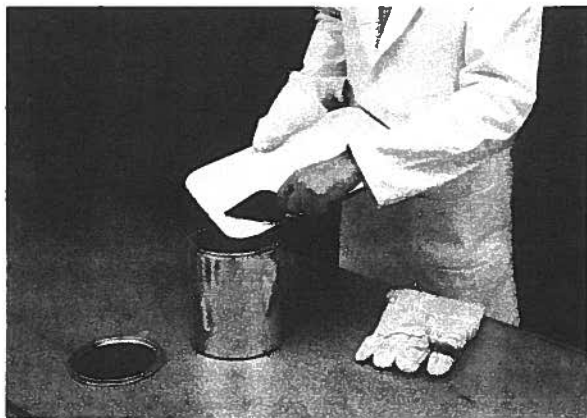
Figure 8 : Le gel de silice chaud est placé dans un contenant métallique que l'on ferme hermétiquement.
