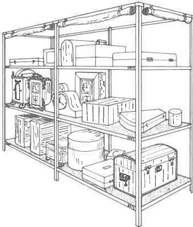
Figure 6: Étagère de rangement idéale pour les objets de taille moyenne. À noter que la tablette du haut ne sert pas au rangement mais à la protection du reste de l'étagère, et que la tablette du bas ne repose pas sur le sol. Sur l'illustration, les rabats anti-poussières sont remontés.
