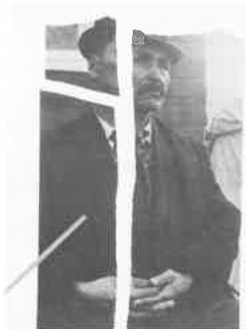
Figure 46: Cette épreuve cassante et non montée s'est fragmentée en plusieurs morceaux; elle présente une fêlure (indiquée par la flèche) et a perdu une partie de sa matière.
