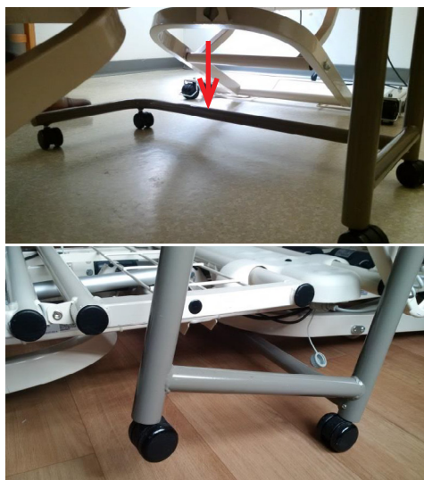
Image 1 : Les barres d'acier du lit sont en contact avec la base de la table.
