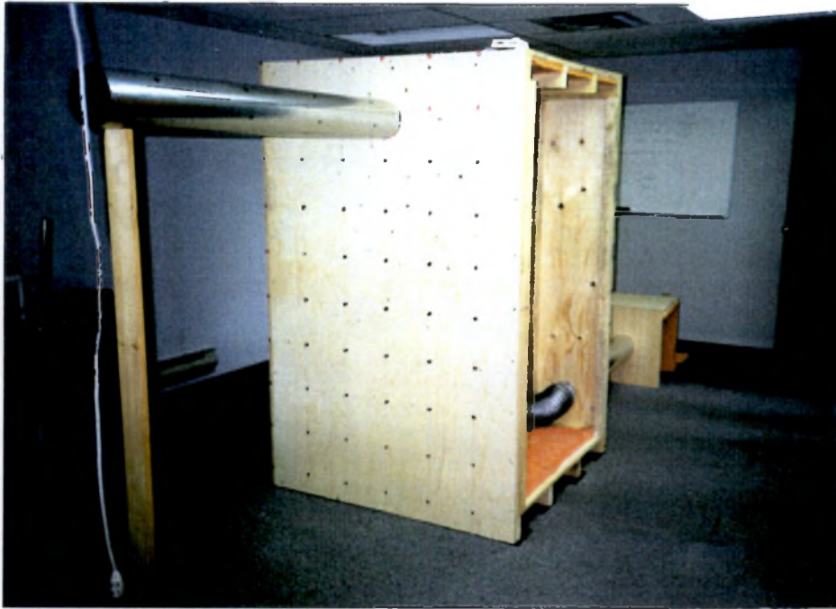
FIGURE 3 Vue de gauche du banc d'essai (conduite à extrémité libre, enceinte montrée ouverte, terminaison sourde)
