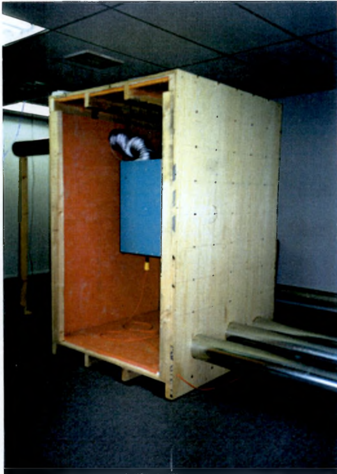
FIGURE 3 Vue de gauche du banc d'essai (conduite à extrémité libre, enceinte montrée ouverte, terminaison sourde)
