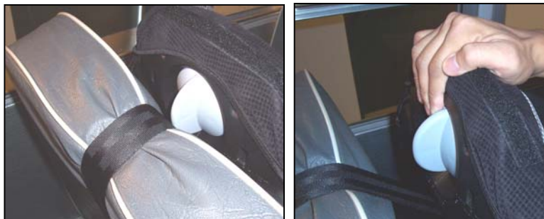
Figure 19. L'installation correcte de l'attache supérieure de l'ERE C (à gauche) permettait tout de même à l'ERE de bouger vers l'avant (à droite).
