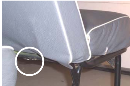
Figure 9. Ancrage d'attache supérieure (autobus scolaire).
