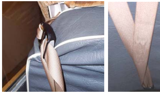
Figure 18. Torsion de l'attache supérieure à double courroie de l'ERE A.
