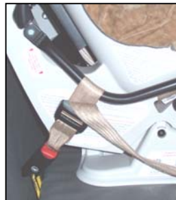
Figure 22. Courroie du connecteur indépendante de l'ERE A.
