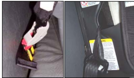
Figure 21. Le crochet à bouton poussoir du connecteur d'attache inférieure installé à l'envers (photo de gauche) et l'entortillement de l'attache inférieure à simple courroie (volet de droite) dans l'autobus scolaire.
