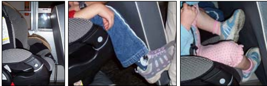
Figure 4. En raison de l'espace limité entre l'ERE et le siège avant, il était difficile à l'enfant de quatre ans et demi (au centre) et à celle de deux ans et demi (à droite) d'y placer leurs jambes/pieds confortablement
