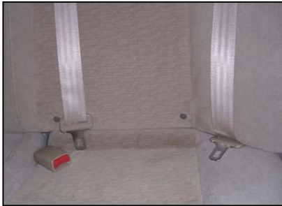
Figure 4. Ancrages inférieurs (voiture).
