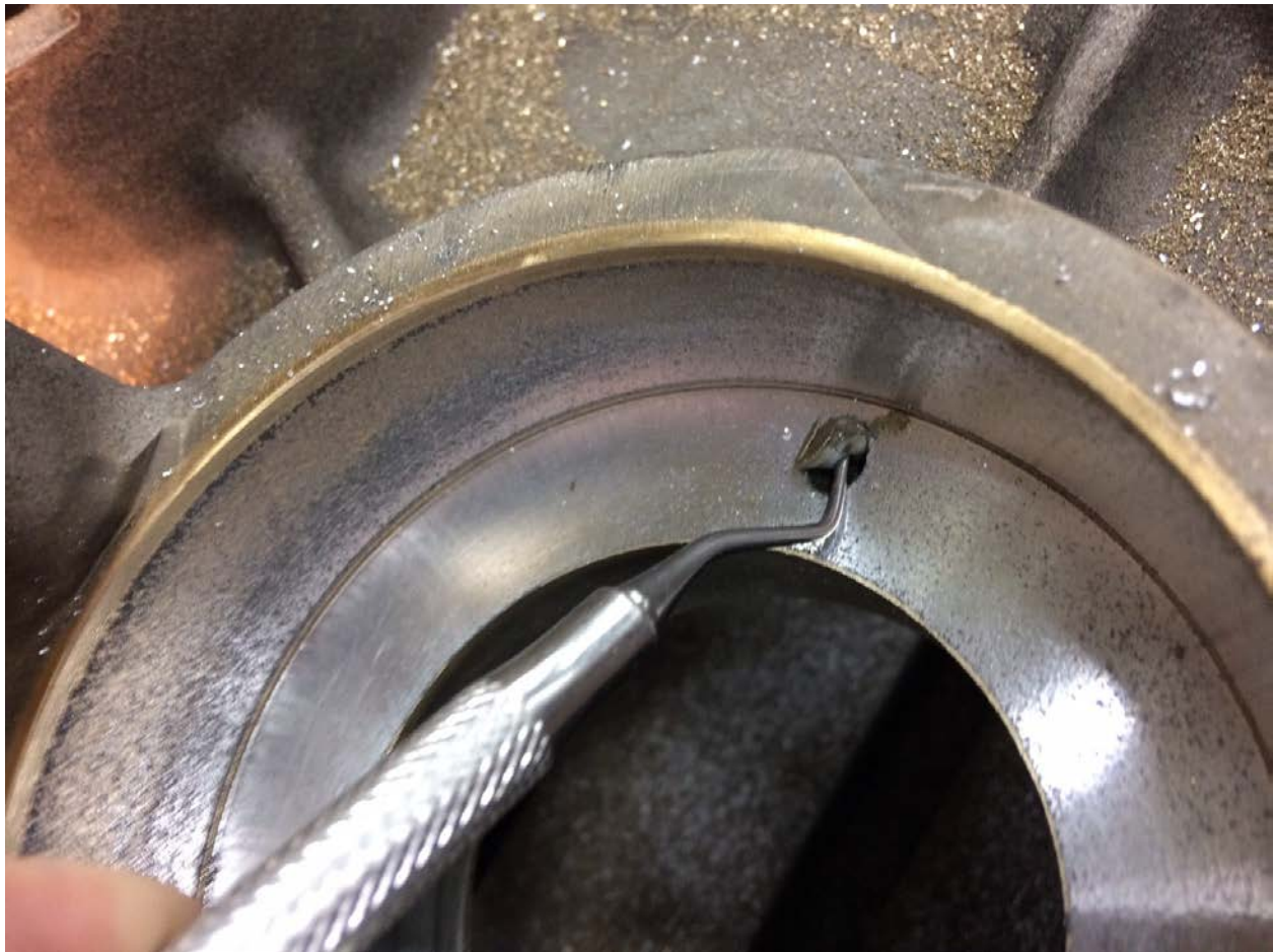
Trou contenant un bouchon en caoutchouc laissé en place après une réparation antérieure
