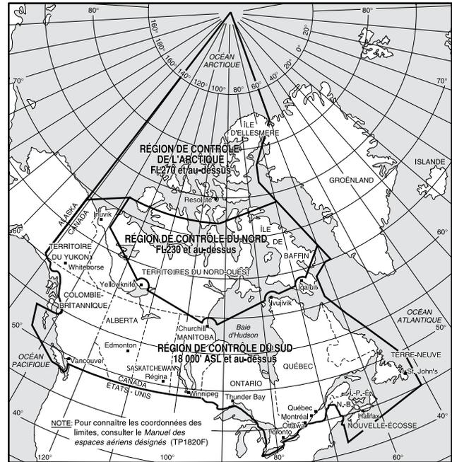
Figure 2.4 – Dimensions verticales des régions de contrôle du sud, du nord et de l'Arctique
