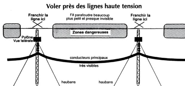
Le faisceau de conducteurs principal se compose de plusieurs gros câbles. Ces conducteurs lourds qui pendent ont un diamètre d'environ deux pouces et sont très visibles. Ils distraient souvent les pilotes qui, alors, ne voient pas les fils parafoudre ou les fils de garde, lesquels sont d'un diamètre beaucoup plus petit.
