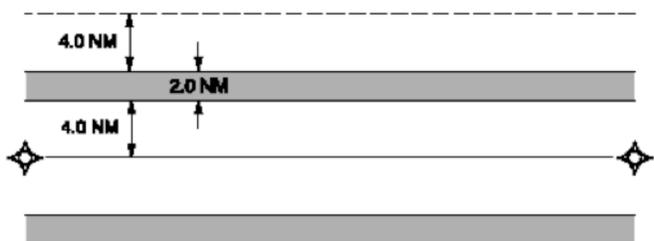
Figure 2.7b) – Coupe transversale d'une route RNAV fixe
