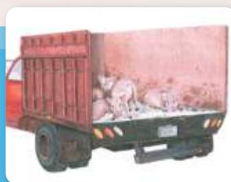
Conditions inappropriées (chargement non sécurisé, plancher inadéquat, exposition aux intempéries, etc.)
