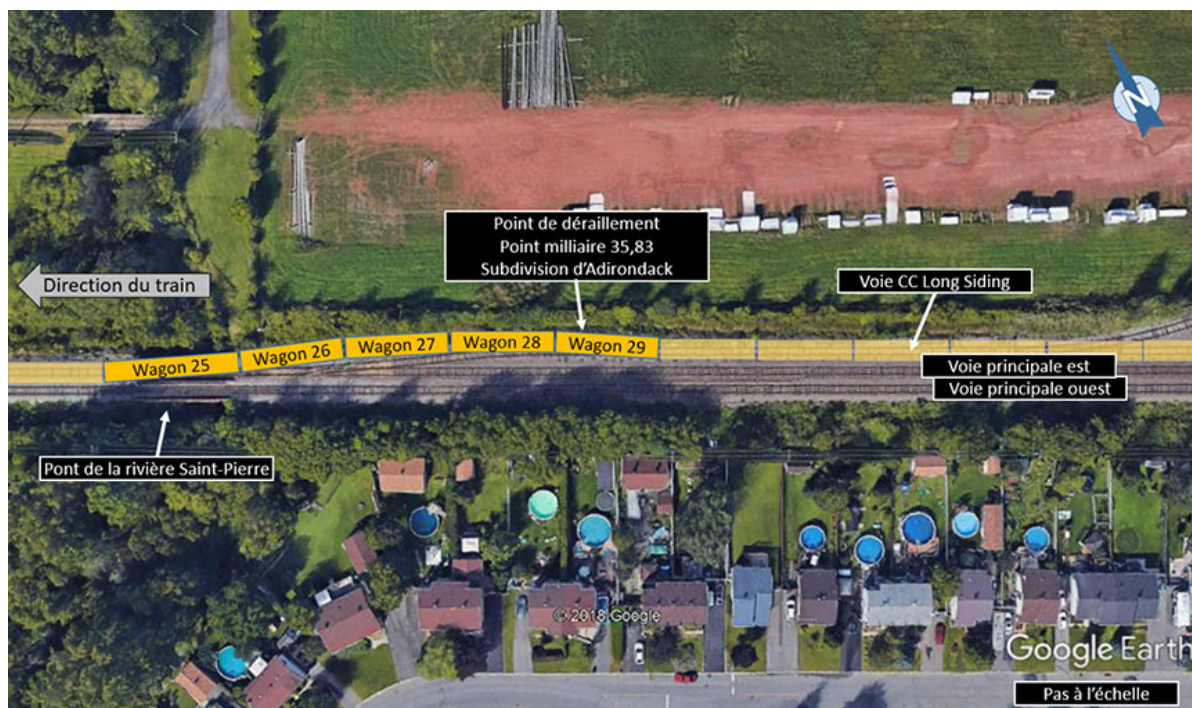
Figure 2. Wagons déraillés à l'extrémité nord de la voie CC Long Siding, à Delson (Québec) (Source : Google Earth, avec annotations du BST)
