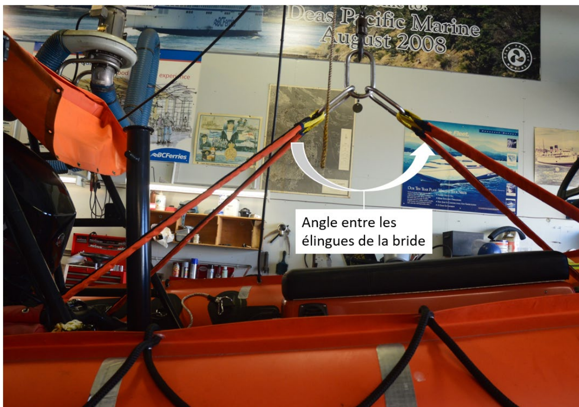
Figure 16. Longueur optimisée des élingues de la bride de l'embarcation de sauvetage (Source : BST)
