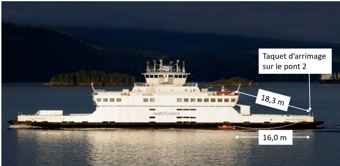
Figure 13. Distance entre le taquet sur le pont 2 et l'embarcation de sauvetage en position rangée et quand elle est à l'eau (Source : Dennis J. Dubinsky, avec annotations du BST)
