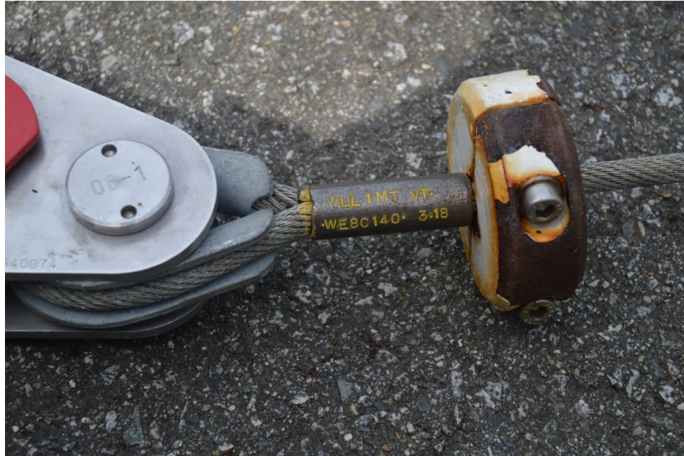
Figure 17. Épissure mécanique d'une charge maximum pratique de 1 tonne métrique (Source : BST)
