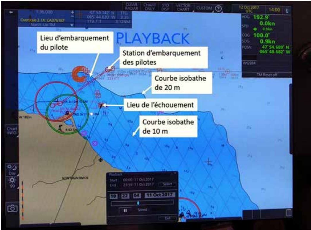
Figure 5. Saisie d'écran de l'ECDIS du SBI Carioca montrant les courbes isobathes de 20 m et de 10 m, avec annotations indiquant la station d'embarquement des pilotes, le lieu d'embarquement du pilote à bord du SBI Carioca et le lieu de l'échouement
