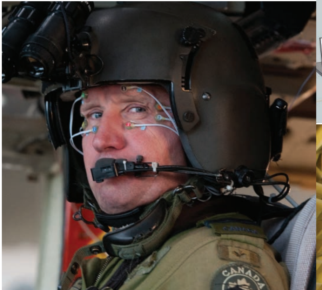
Le CNRC a utilisé des capteurs électro-oculaires pour saisir les mouvements de l'œil du pilote dans le cadre d'un projet visant à analyser la charge de travail de l'équipage.
