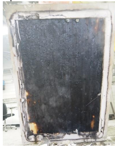
(d) char on CLT substrate
