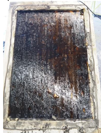
(d) char on CLT substrate
