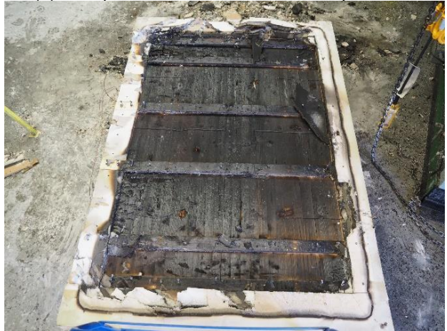
(d) char on CLT substrate
