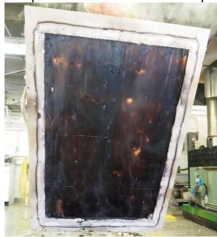
(d) char on CLT substrate
