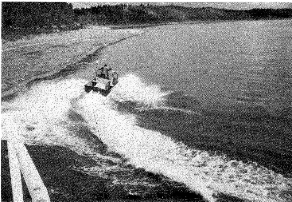
FIG. 2. Jet boat Loon sounding at high speed on the Mackenzie River using Mini-ranger positioning system. Embarcation à réaction Loon effectuant des sondages à haute vitesse sur le fleuve Mackenzie, à l'aide du système de navigation Mini-ranger.
