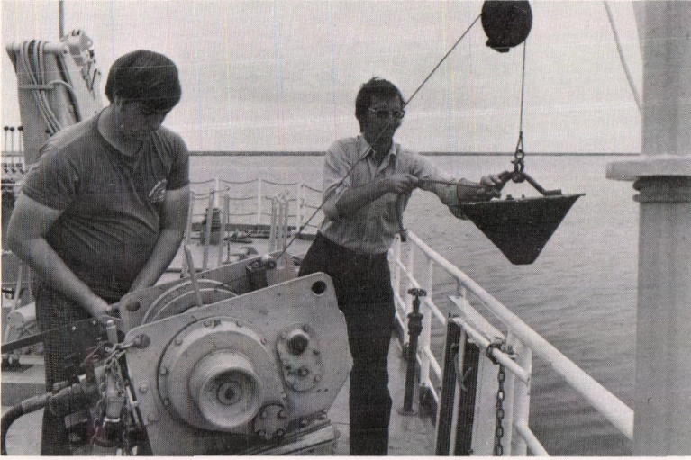
FIG. 5. Using the cone to check the echo sounder. Utilisation du cône permettant de vérifier le fonctionnement de l'écho-sondeur.
