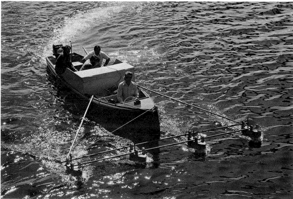
FIG. 13. A new Raytheon DE719 channel sweep depth recorder that gives 100% bottom coverage. Nouvel écho-sondeur Raytheon DE719 à balayage de canaux et à exploration totale.
