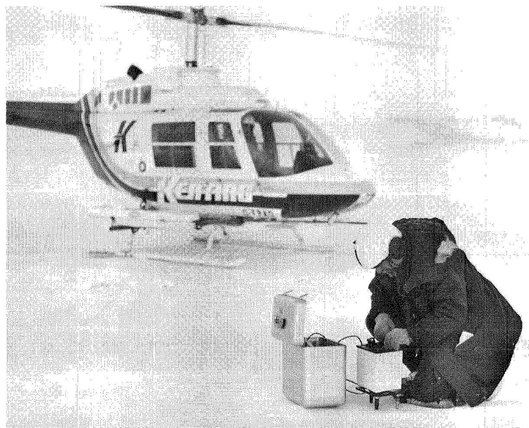
FIG. 12. Solar cells used to charge batteries at radio navigation/transmission site, Viscount Melville Sound. Piles solaires pour le chargement des accumulateurs au poste d'émission radiophonique de radio navigation, bassin du Viscount Melville.
