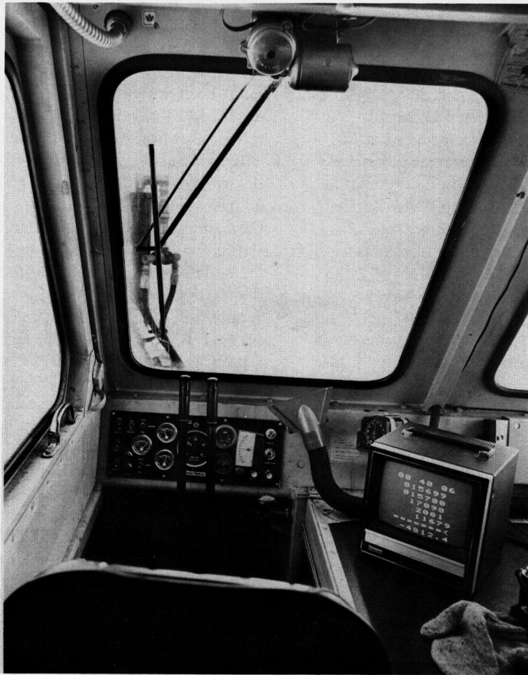
FIG. 14. Navigation display for tracked vehicle operator. Écran de navigation pour le conducteur de véhicules à chenilles.
