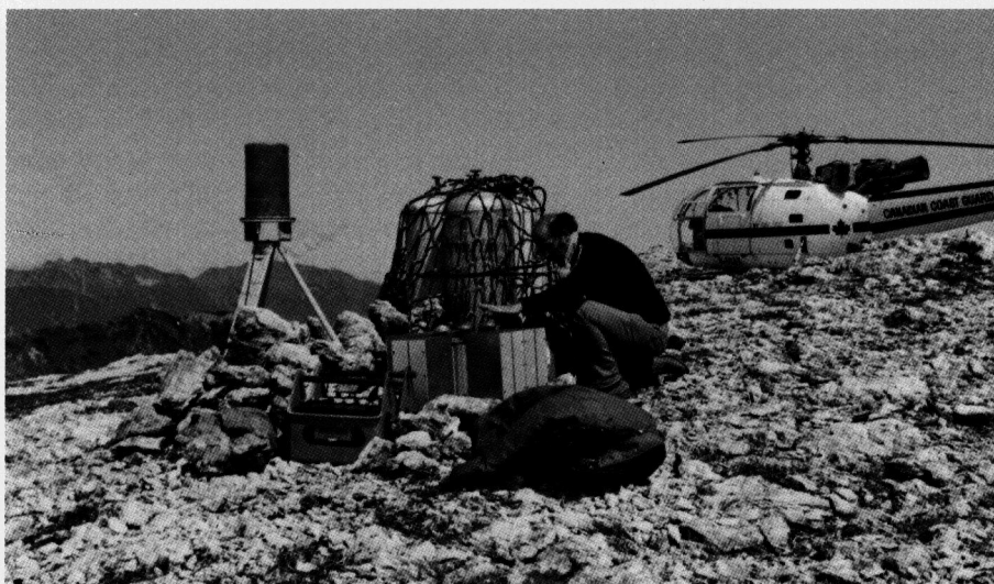
FIG. 27. Setting up RPS Station on Mount Russ, Queen Charlotte Islands. Installation d'une station RPS sur le mont Russ, dans les îles de la Reine-Charlotte.
