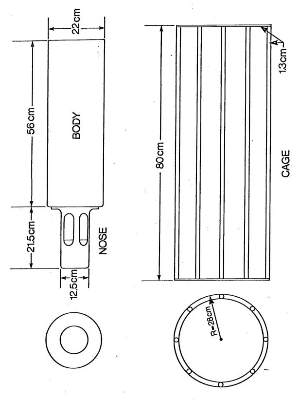
EIGHT BARS AT 1.3cm @ EQUALLY SPACED.
