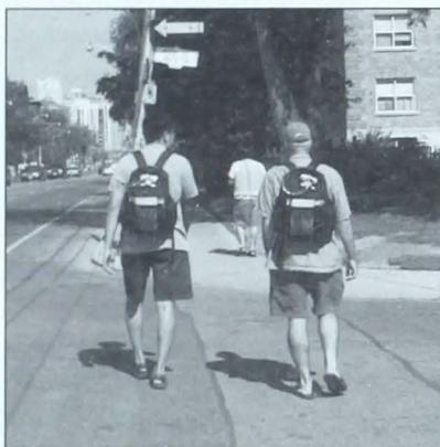
Des bénévoles transportent des échantilleurs miniatures dans leur sac à dos pour déterminer leur exposition personnelle aux polluants atmosphériques durant l'étude torontoise sur le smog. Chaque sac contient un échantilleur permanent de monoxyde de carbone, un échantilleur passif de dioxyde d'azote et de dioxyde de soufre et deux filtres recueillant de fines particules.
