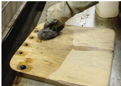
Nettoyez la surface décapée au moyen d'un tampon de laine d'acier humide plutôt que de la laver à grande eau, avec un boyau.
