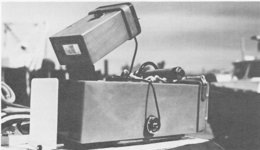
a) Appareil de photomicrographie sous-marine avec flash en position d'éclairage réfléchi
