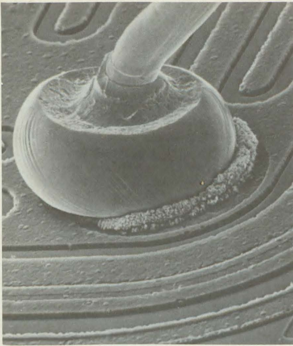
Micrographie à balayage électronique des composés métalliques par le fil d'or de 0,0012 mm d'un transistor refusé pour la navette spatiale de la NASA.
