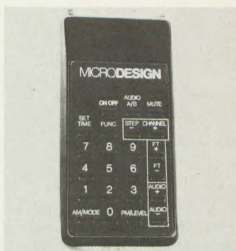
Contrôleur automatique d'antenne Microdesign commandé par microprocesseurs en 4 GHz en mode polaire et par polarisation. Clavier relié au dispositif de commande et au récepteur Electrohome en 4 GHz.
