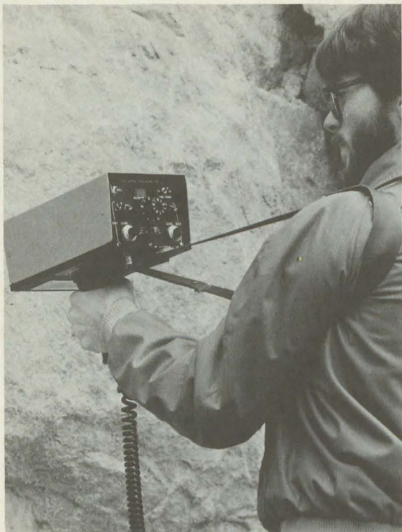
Radiomètre rapporteur Barringer manuel pour vérification au sol et amélioration de l'interprétation de l'imagerie LANDSAT ou SPOT.
