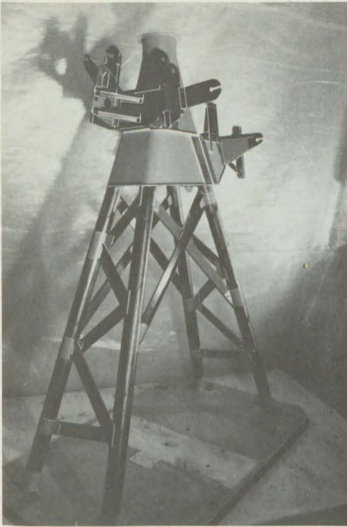
Bâti d'antenne légère, en graphite époxyde et en kevlar, fabriqué par Boeing pour les satellites de télécommunications.
