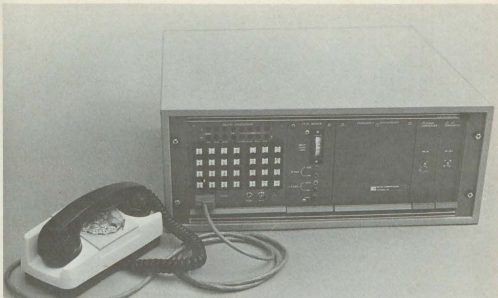
Terminal mobile à un canal par porteuse pour télécommunications UHF par satellite, garantissant une phonie d'une qualité réelle et la transmission des données synchrones et asynchrones grâce au programme MUSAT.
