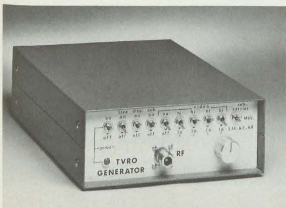
Générateur Electrohome TRT de signaux d'essai pour vérifier le fonctionnement des récepteurs de signaux de satellites, avec sortie en 1 GHz et 4 GHz.
