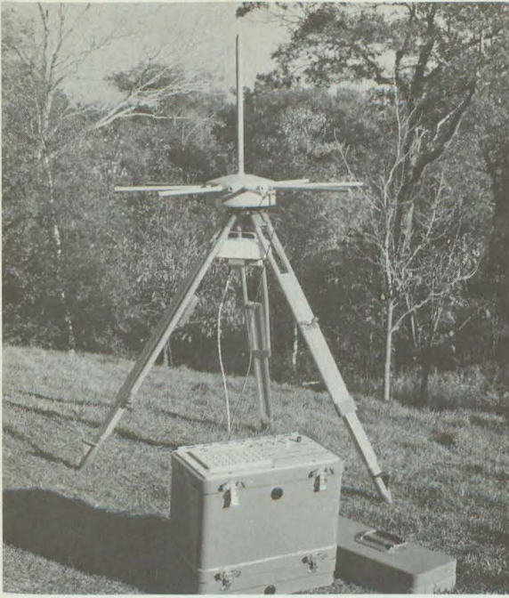
Équipement type CMC pour positionnement de précision des satellites aux fins de relevés ou de navigation.
