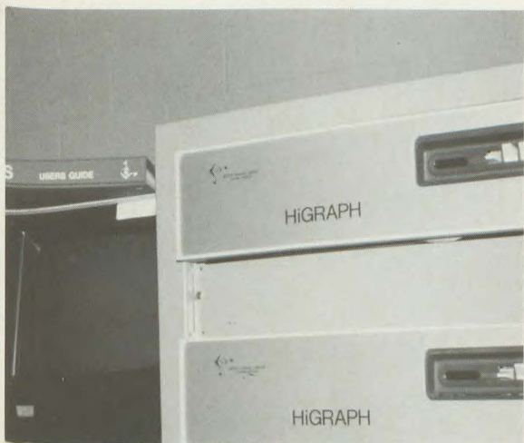
Dispositifs graphiques autonomes du système HiTech d'acquisition des données pour affichage simultané de trois graphiques en temps réel et d'un graphique en différé.
