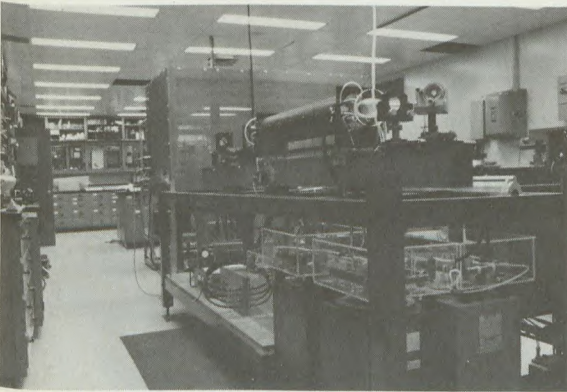
Laser à iode atomique à déclenche- ment par injection utilisé dans les expériences de physique des plasmas.
