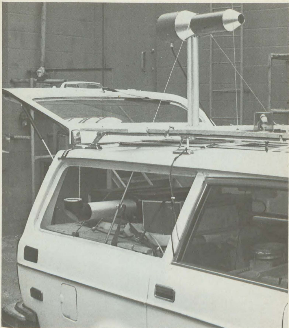
Prise d'air pour détecteur mobile rapide de \text{SO}_2 dans l'atmosphère, monté sur le toit d'une automobile avec un PLUMETRACKER.
