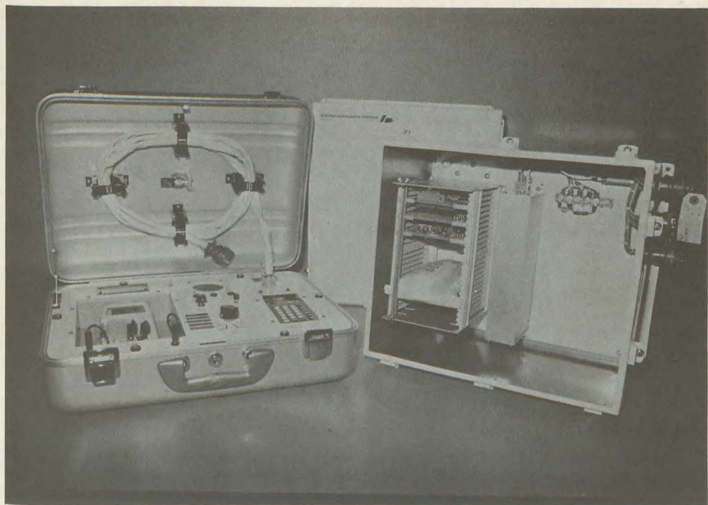
Plate-forme Bristol pour collecte de données par satellite (droite) et matériel d'essai.
