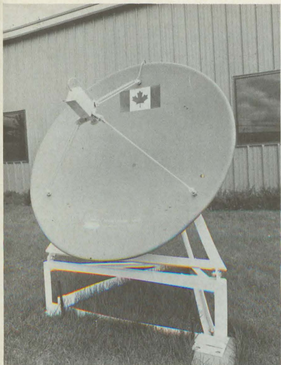
Terminal SED de diamètre réduit pour radiotélédiffusion directe par satellite en 12 GHz.
