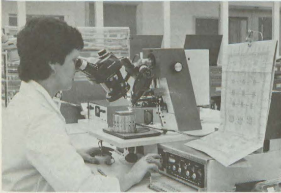
Fabrication de microcircuits hybrides CMC pour utilisations spatiales et autres.
