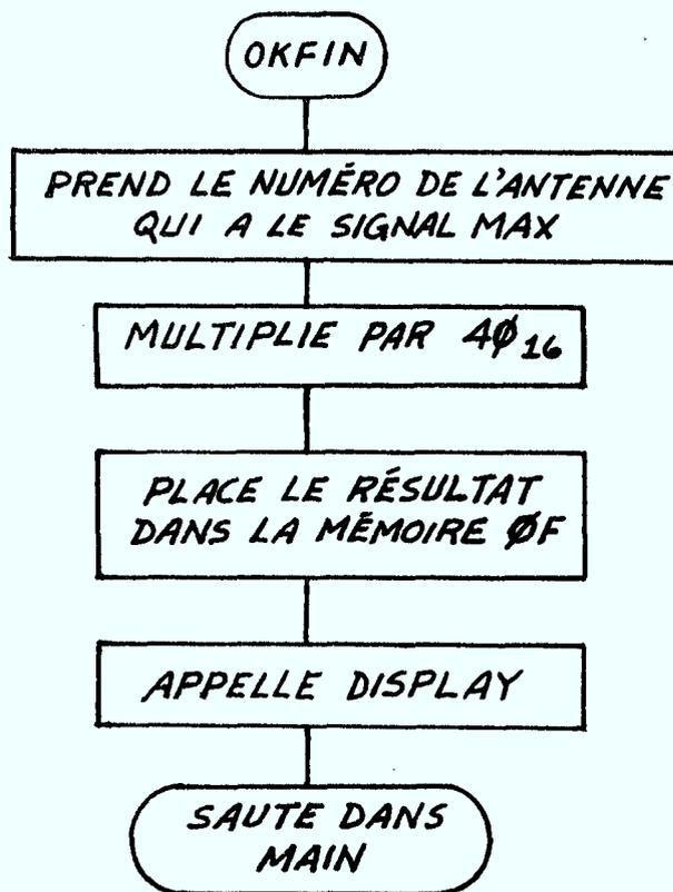
OKFIN place le pointeur de direction (mémoire  $\phi F_{16}$ ) dans la direction d'une des 4 antennes, i.e. la direction d'arrivée est en ligne avec une des antennes.
