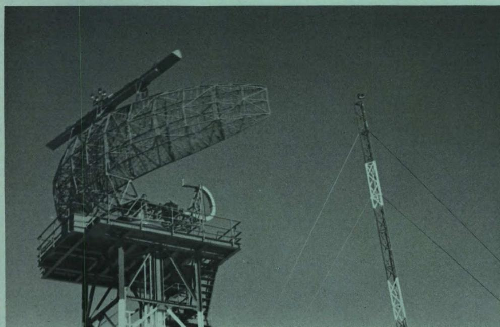
L'antenne à gain élevé (34 db) Raytheon présente un raccord RF à double rotation permettant au radar de fonctionner comme primaire et comme secondaire et de choisir une polarisation linéaire ou circulaire des ondes RF par commutation à distance.
