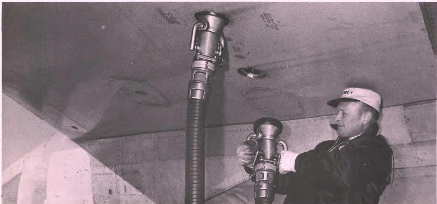
La Société Emco peut concevoir et fabriquer selon les besoins spécifiques de chacun de ses clients, des raccords, coupleurs et becs d'alimentation spéciaux. • Special adapters, couplers and nozzles are designed and built to customers' specifications in Emco's quality refuelling equipment. • La Emco fabrica equipo para re-abastecimiento de la más alta calidad y diseña adaptadores, acopladores y boquillas a las especificaciones del cliente.
