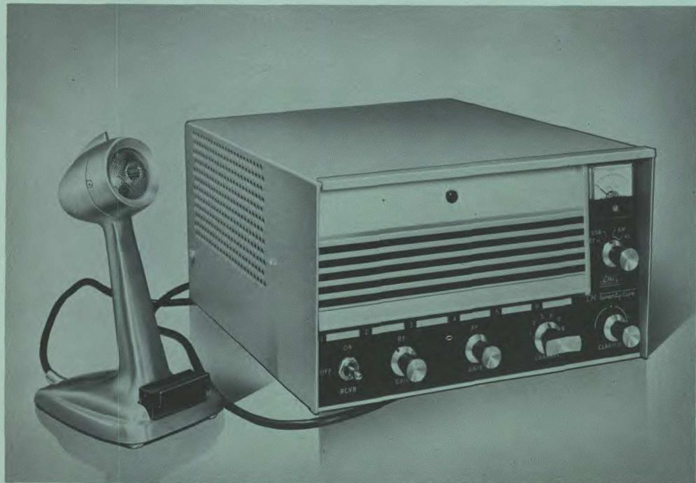
Le poste radiotéléphonique CH25 de Canadian Marconi répond aux applications fixes, sur véhicules, à bord d'avions ou de navires, les plus diverses. • Canadian Marconi's CH25 radio-telephone satisfies a wide range of fixed, vehicular, airborne and shipboard applications. • El radioteléfono de la Canadian Marconi CH25 satisface las demandas en una gran variedad de aplicaciones, como equipo fijo, en vehículos, en aviones o en barcos.
