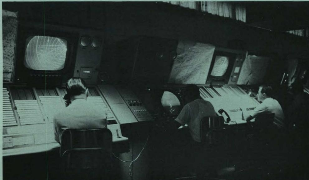
Le contrôle du trafic aérien à l'aéroport international de Toronto, second en importance du Canada. Le centre de contrôle est basé au point d'affichage du radar de surveillance primaire; des contrôleurs, à droite et à gauche, dirigent les écrans brillants de radar à balayage converti.
