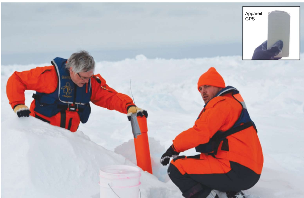
Déploiement d'une balise GPS sur la glace pour surveiller les déplacements des concentrations de mises bas des phoques du Groenland, mars 2017 (photo : A. Buren).
