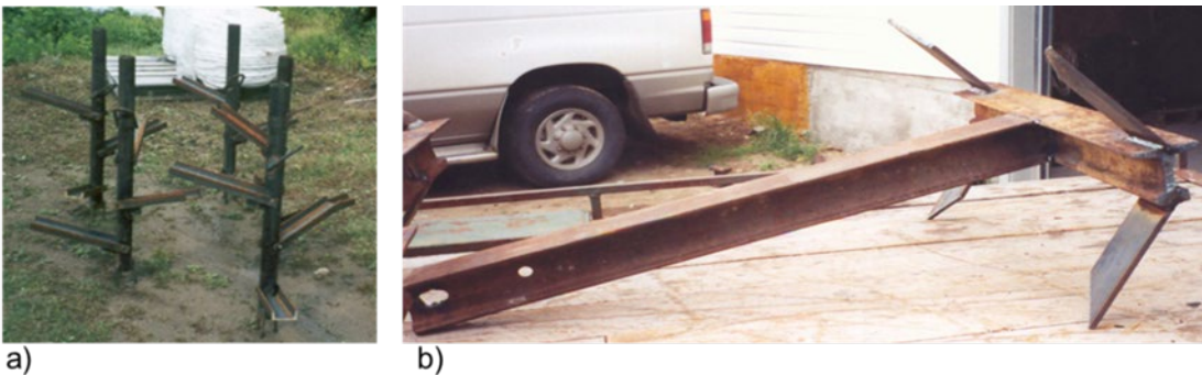
Figure 9. Ancres : a) Le système d'ancre japonaise, b) Ancres à deux pattes construites avec des rails de chemin de fer.
