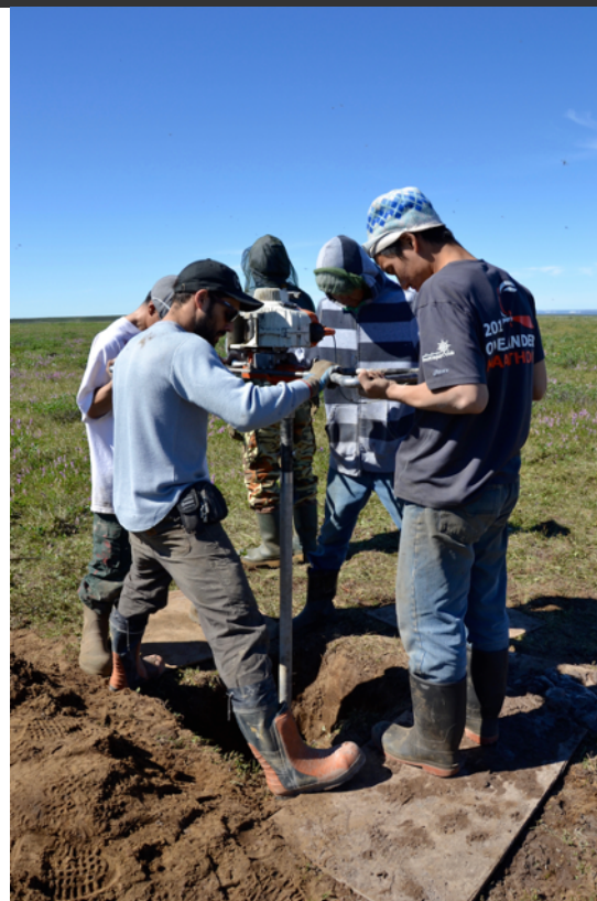
Carottage du pergélisol dans le parc territorial Kugluktuk, au Nunavut
