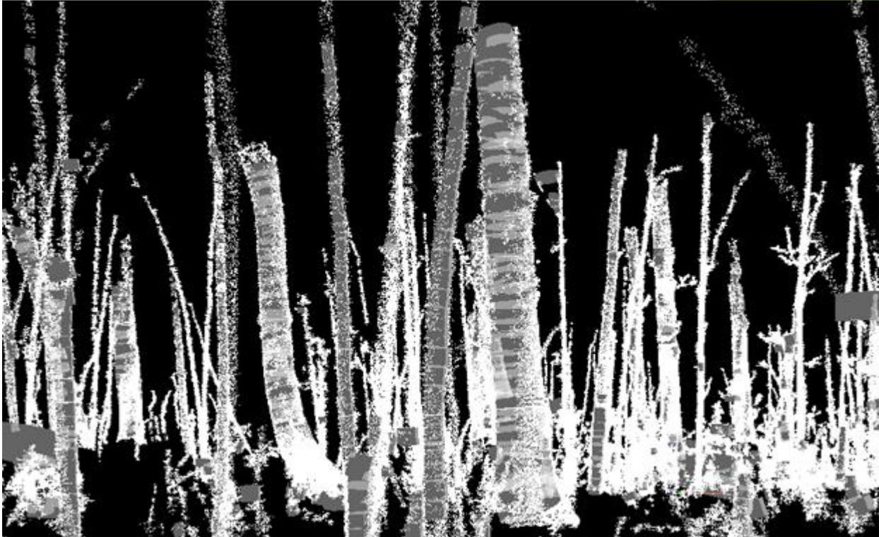
Une image au sol acquise par la technologie LIDAR (détection et télémétrie par ondes lumineuses), utilisée pour estimer avec précision certains paramètres forestiers comme le volume, la forme et la densité du peuplement.
