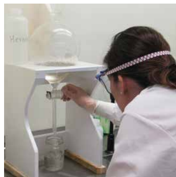
B) On filtre ensuite les matières restantes à l'hexane et à l'eau pour capter les larves au deuxième stade larvaire et les débris.
