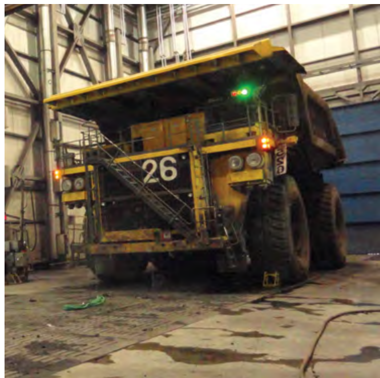
Un véhicule de transport de minerai en service dans une mine de charbon canadienne entre dans des installations d'entretien dotées de l'équipement pour faire l'entretien de véhicules alimentés au gaz naturel
