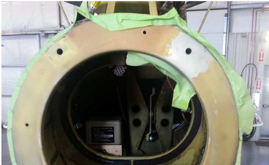
Fissure dans la cloison arrière du fuselage près de la ferrure de fixation droite de la poutre de queue.
