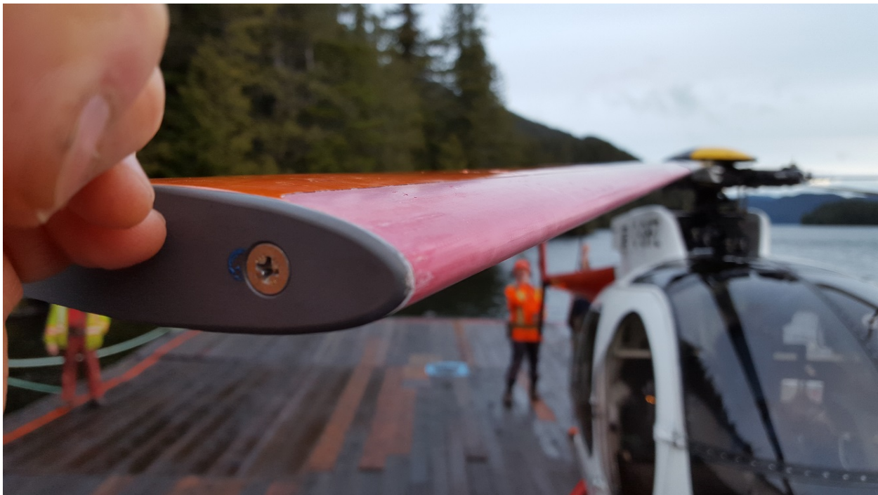
Pale de rotor principal sans bande anti-abrasion de bord d'attaque suite à sa perte en vol
