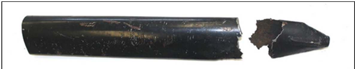
Figure 2. Dommages à l'ensemble de mâts de voilure du longeron principal gauche (Source : BST)
