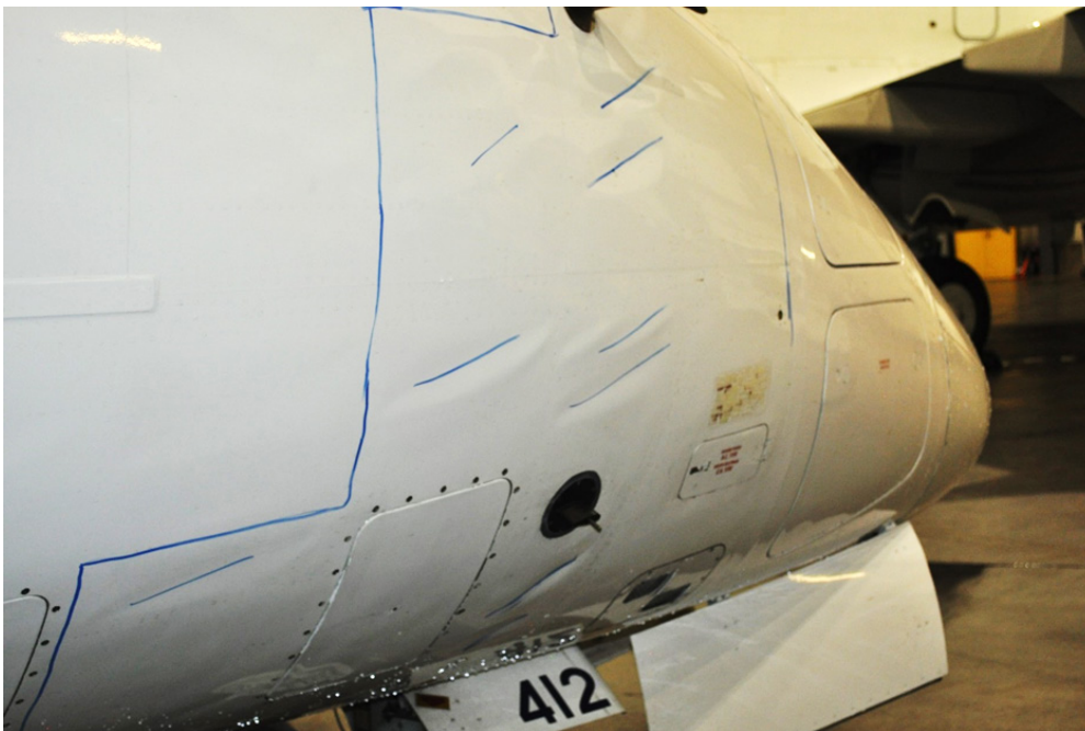
Figure 2. Revêtement ondulé du côté droit du nez (marqueur bleu à essuyage à sec ajouté à des fins d'illustration) (Source : BST)
