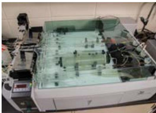
Analyseur de flux segmenté du Laboratoire de recherches sur les grains
