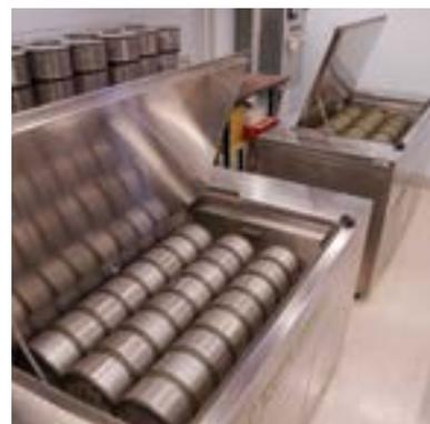
Système de micromaltage Phoenix du Laboratoire de recherches sur les grains
