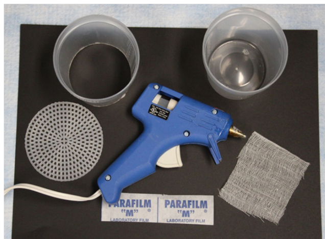
Figure G-1 Matériaux nécessaires pour construire un récipient d'extraction à la chaleur : des gobelets de polypropylène de 4,5 oz (2 par récipient), un canevas circulaire en plastique de 14,6 cm, un pistolet à colle, une gaze et des bandes de Parafilm®.
