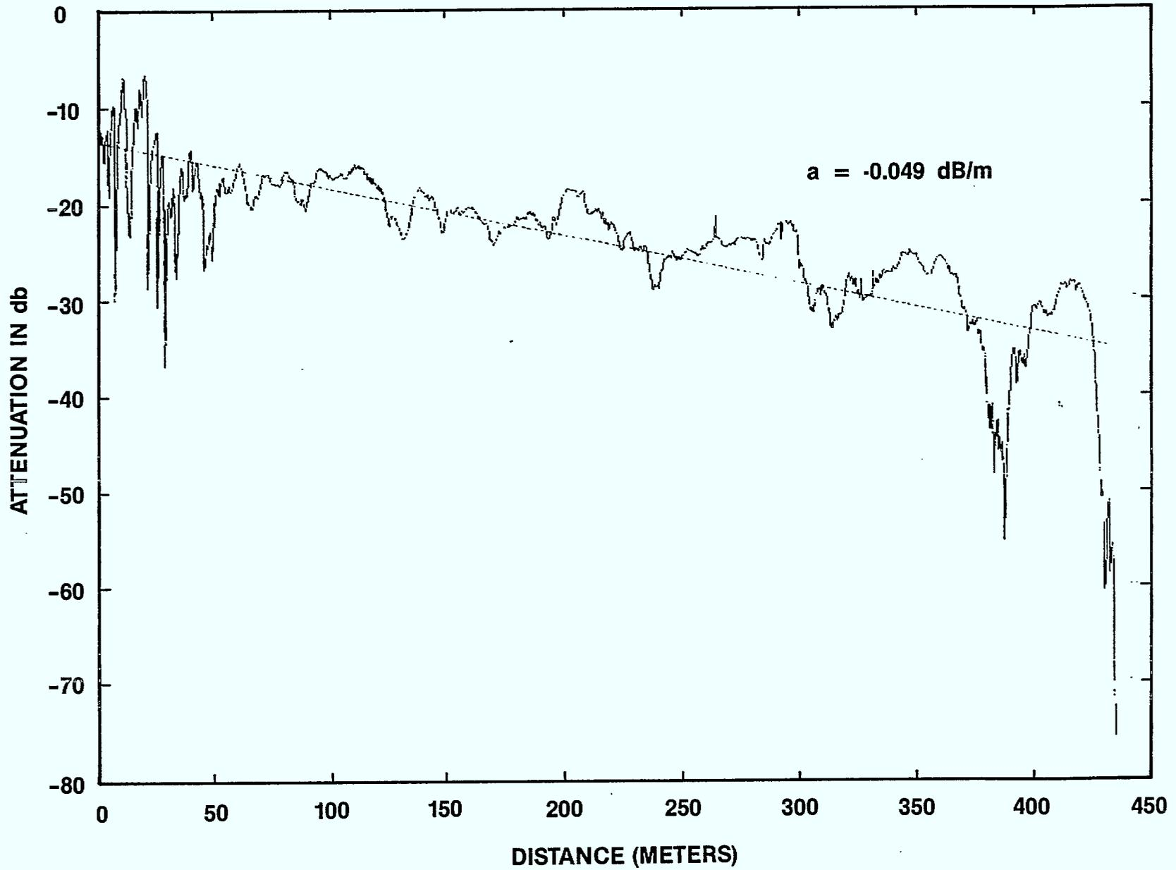
FIG 3. LOSSES AT 900 MHZ IN POTASH TUNNEL
