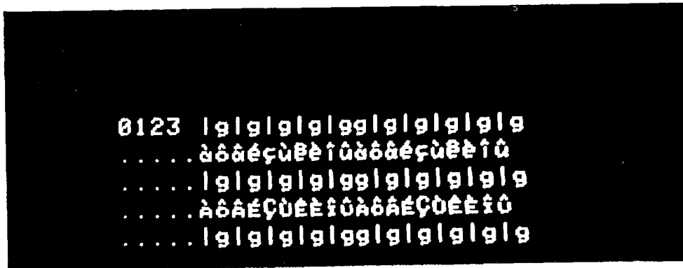
Figure 1(a). Position des accents selon la méthode 1 dans le cas de lettres ascendantes et descendantes
