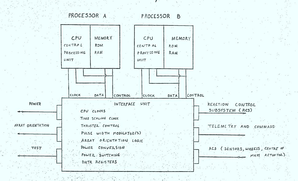
FIGURE I ACS COMPUTER BLOCK DIAGRAM
