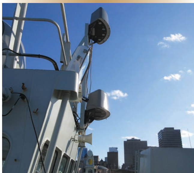
Figure 4. La configuration de l'antenne de la superstructure du NDC pour le SATP Puma a fait l'objet de plusieurs itérations de développement, de conception et d'intégration pour obtenir le meilleur ajustement possible.
