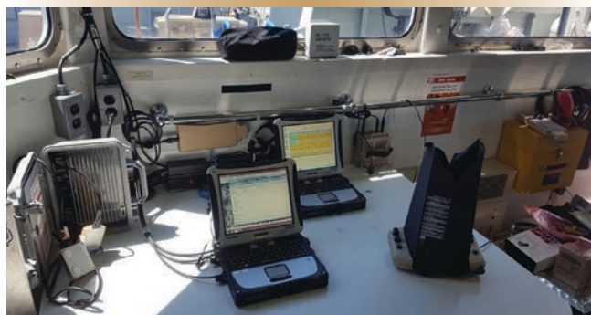
Figure 3. Contrôleur portable du système Puma avec ordinateurs portatifs de planification et d'entretien de la mission sur la passerelle d'un NDC.
