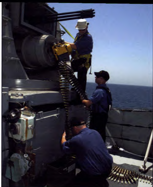
Les techniciens en armement naval du NCSM Ottawa remplacent les obus de 20 mm à noyau de tungstène du système de défense rapprochée Phalanx anti-missile et anti-avion. (Photo NCSM Ottawa, par le Cpl Charles Barber, AP2002-E018-20a)
