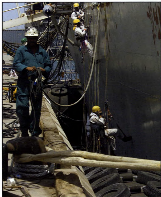
Le personnel du SLA coordonnait la maintenance de routine, comme ces retouches de peinture à la coque du Fredericton lors des visites des navires dans les ports du Golfe. (Photo NCSM Fredericton, par le Cpl Mike Selig, HS032540d06)
