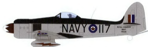
Hawker Sea Fury FB11 740 km/h - 10.4 m x 11.7 m x 5 m - 4,190 kg VF 870, NCSM Magnificent , 1953
