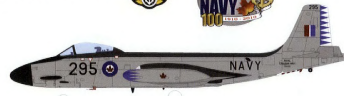
McDonnell F2H-3 Banshee 933 km/h - 14.7 m x 13.7 m x 4.4 m - 5,980 kg VF 870, NCSM Bonaventure , 1960
