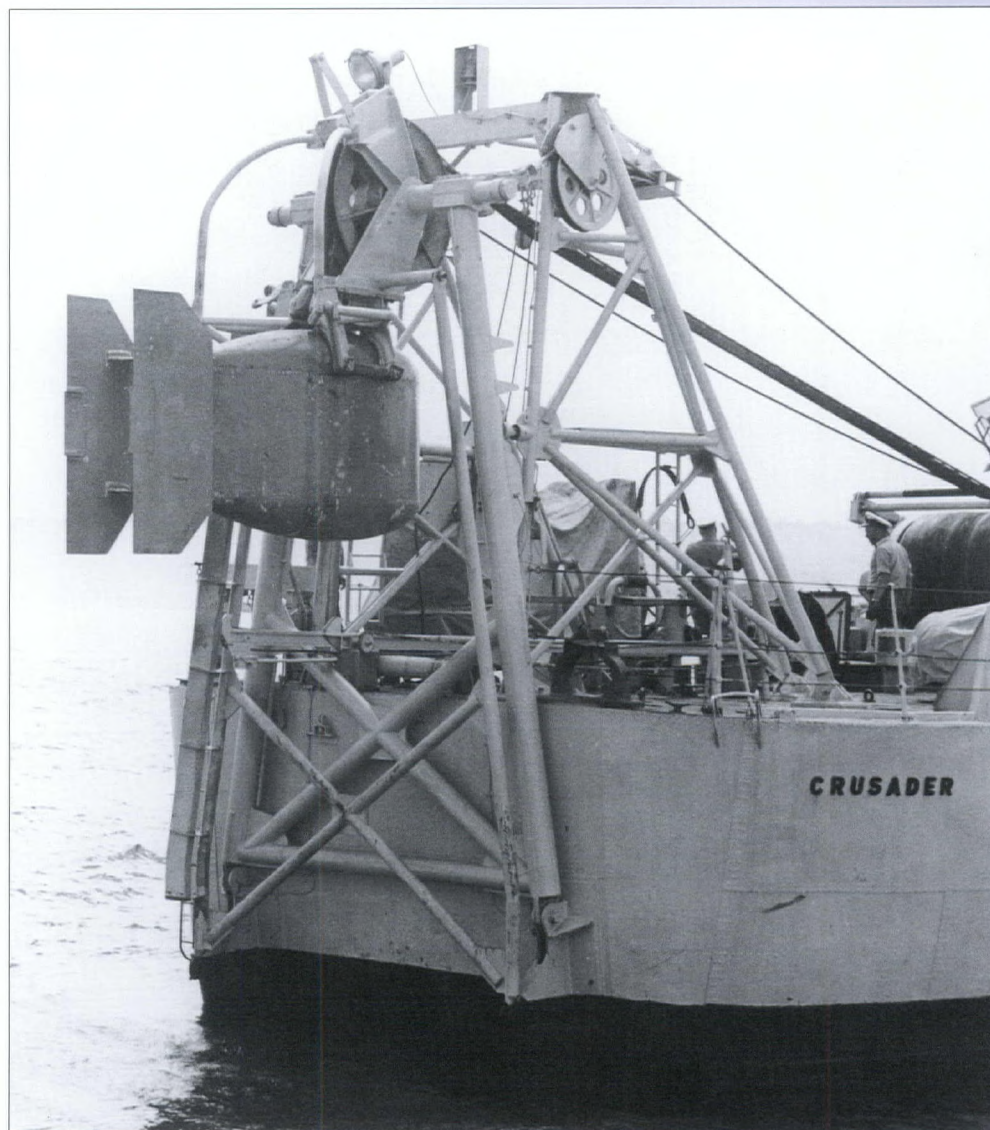
Essais du prototype CAST 1/X du sonar à immersion variable, installé sur le destroyer Crusader .
