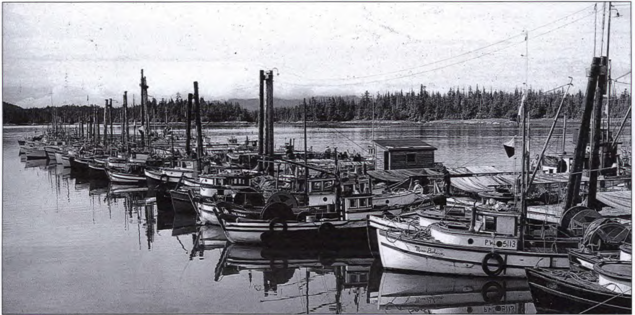
Certains bateaux sur cette photo non datée sont munis de tambours d'enroulement des filets maillants, mis au point durant les années 1930.
