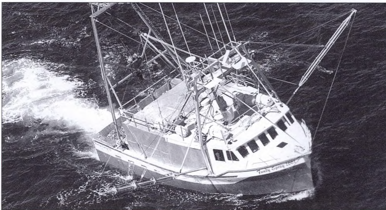
Les bateaux de petites et moyennes dimensions construits durant les années 1980 et 1990 étaient fréquemment plus gros que ceux des années précédentes, notamment au niveau de la superstructure. L'utilisation de stabilisateurs, comme ceux que l'on aperçoit sur ce bateau du sud-ouest de la Nouvelle-Écosse construit à la fin du millénaire, se répandit.
