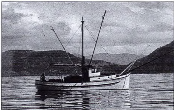
Photo non datée d'un ligneur montrant les perches qui suspendent les lignes garnies d'hameçons.
