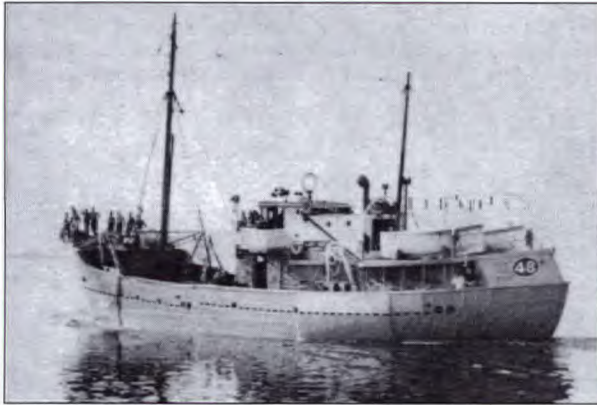
Le chalutier à propulsion diesel Cape North , un exemple des bateaux qui remplacèrent les goélettes de pêche à la palangre pour approvisionner l'industrie du poisson congelé.
