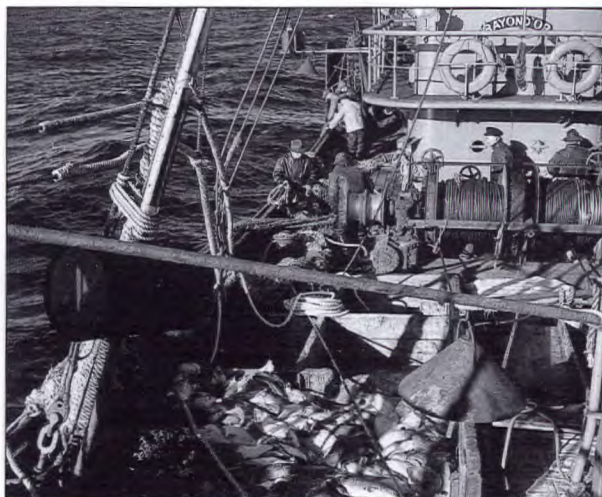
Une vue du pont d'un chalutier à perche latérale. Ces chalutiers ont progressivement remplacé les goélettes avant d'être remplacés, à leur tour, par les chalutiers à pêche arrière. (Office national du film)
