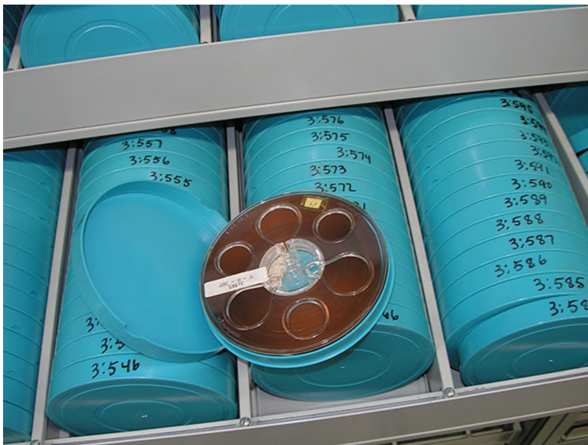
© Gouvernement du Canada, Institut canadien de conservation. ICC 131917-0002 Figure 2. Bandes sur bobines correctement entreposées.
