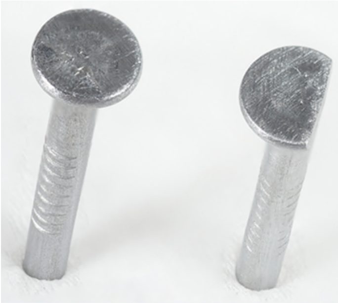
© Gouvernement du Canada, Institut canadien de conservation. ICC 129916-0003 Figure 5. Deux clous de fer. La tête du clou apparaissant à droite a été limée afin que le rebord soit au ras de la tige du clou.
