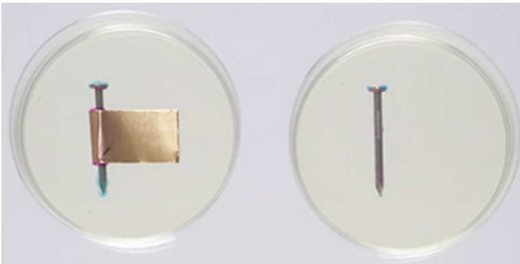
© Gouvernement du Canada, Institut canadien de conservation. ICC 129916-0006 Figure 7. Clou de fer et feuille de laiton dans une boîte de Petri (à gauche) et clou de fer dans une boîte de Petri (à droite), deux minutes après que la solution de gélose eut été versée dans les boîtes de Petri. De petites régions rosées et bleutées commencent à apparaître.
