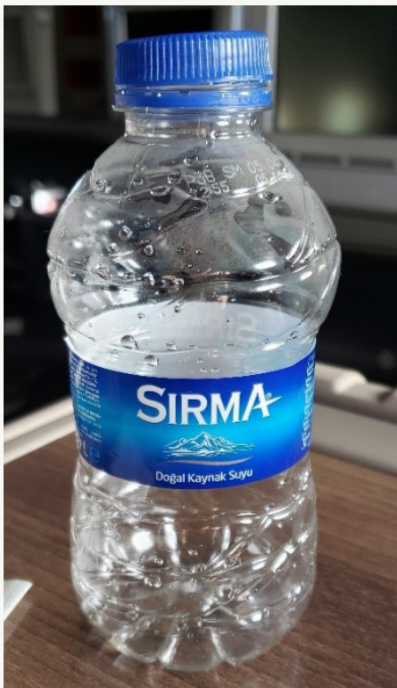
BOUTEILLE D'EAU EN ÉQUILIBRE DE PRESSION EN ALTITUDE DE CROISIÈRE.
