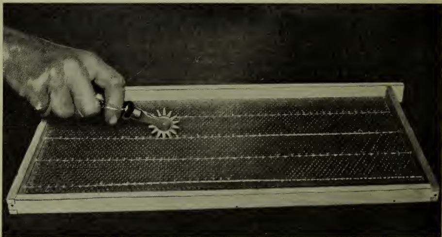
Fig. 9. — Eperon pour noyer le fil de fer.
