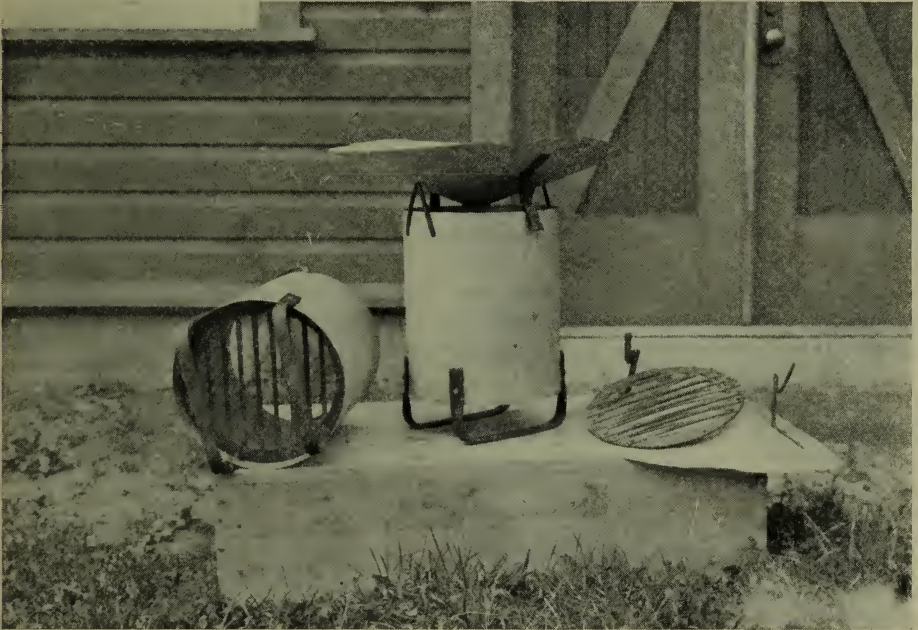
Ce genre de poêle à charbon de bois est très utile pendant la saison pluvieuse, lorsque le séchage à l'air se fait difficilement.
